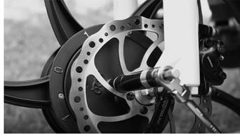
2. 鬆開車輪：對準打浪輪轉盤，插入套筒工具組，逆時針轉開約 4~5 圈。
