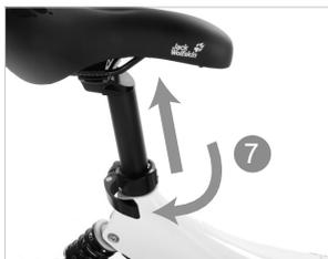
鬆開座管束，拉起座管至適當高度。
