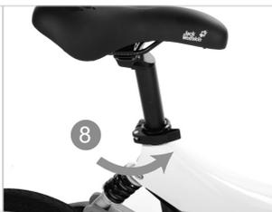
調節螺絲後鎖緊座管束，搖動並下壓座墊確認無晃動或下沉。
