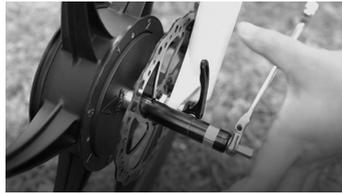
4. 鎖緊車輪：指針指向預定段次後，再次插入套筒工具，順時針鎖緊車輪。
